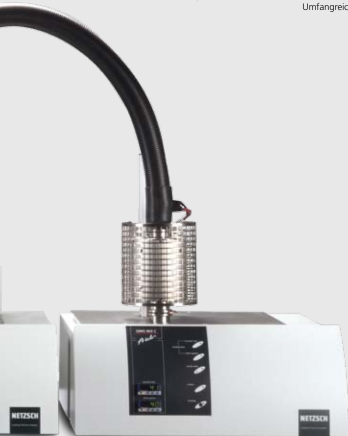
Kopplung des Tensor 27, externe Gaszelle, TG 209 F1 Libra ® und QMS 403 C Aëolos ®
